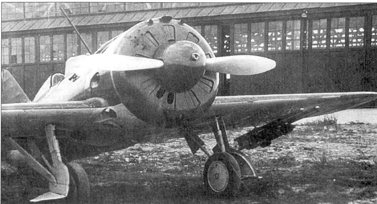
И-16 тип 29 с подвешенными реактивными снарядами РС-82 на испытаниях.
